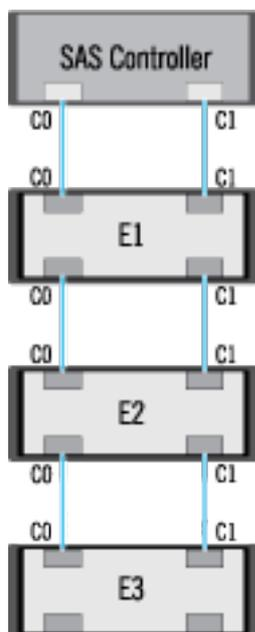
Si se pierde el canal de comunicación entre el conector y el primer gabinete, la Configuración de ruta redundante se pierde. En este caso, la condición del conector lógico se muestra como crítica. Diríjase a
